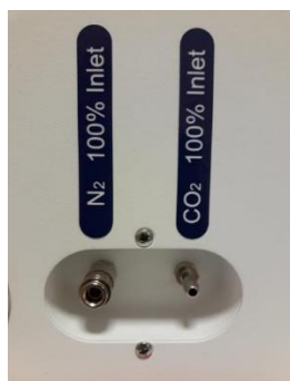
Joonis 11.1 Gaasi sisendpordid Mini MIRI® Dry ja Mini MIRI® Humidity mitmekambrilistel kehavälise viljastamise inkubaatoritel
