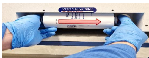
Joonis 12.2 VOC/HEPA-filtri paigaldamise ja eemaldamise protseduur
