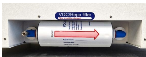
Joonis 12.3 Õigesti paigaldatud VOC/HEPA-filter
