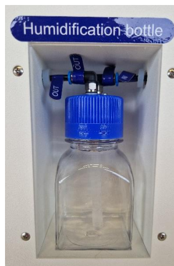
Joonis 22.1 Toru ühendus niisutus pudelil ja Mini MIRI® Humidity mitmekambrilisel kehavälise viljastamise inkubaatoril.
